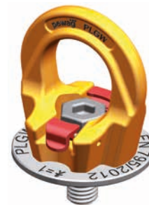
Obrázek 4: Poloha ‚B‘. Bez dotyku klapky se šroubem. Pouze v této poloze je vázací bod připravený k použití.
